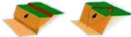
Figura 8 - Ruptura planar e em cunha.
